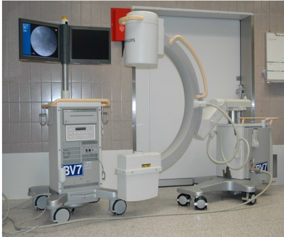
Een mobiel apparaat, vanwege de vorm ook C-boog genoemd voor doorlichting tijdens operaties.
